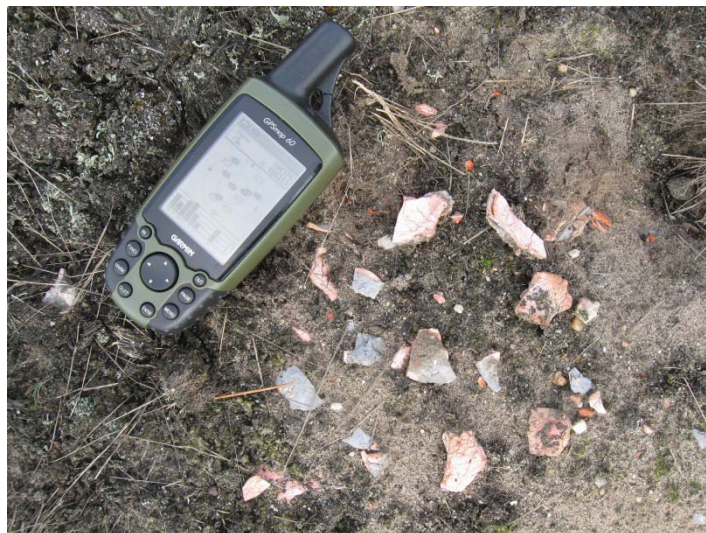
fig 4.2.2 ; Verfschilfers van PTT zendmast
