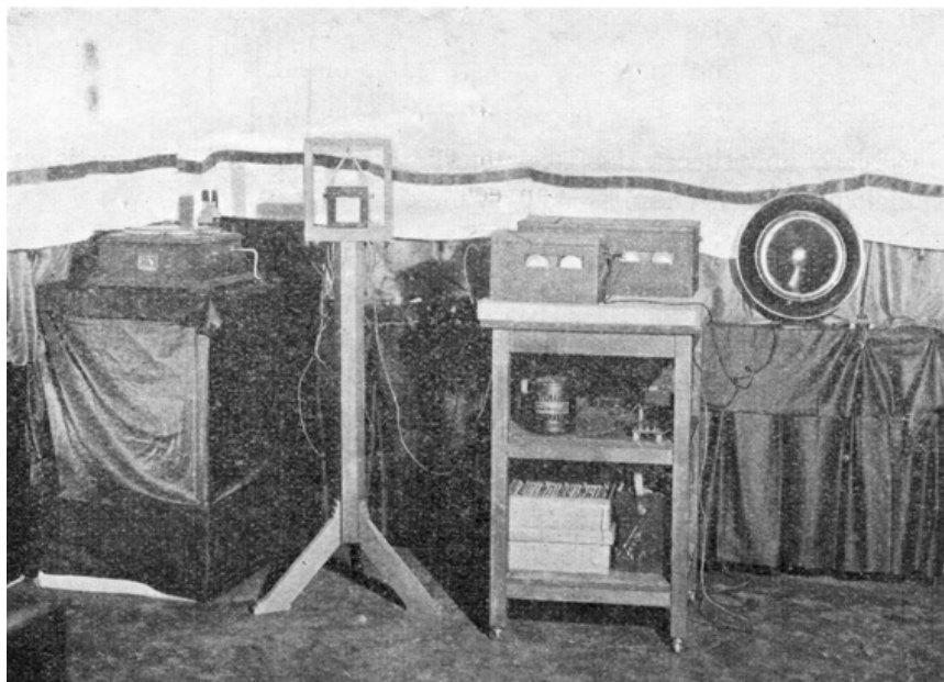
Fig. 62. De studio in het Natuurkundig Laboratorium te Eindhoven met gramfoon met electromagnetische weergever, Reiszmicrofoon en bijbehorende versterkers (tijdelijk in de studio opgesteld voor enkele proeven).
